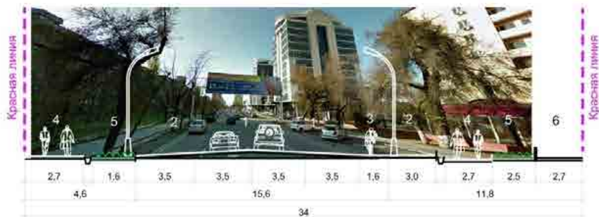
Типовой поперечный профиль 1-1. Магистральной улицы районного значения.
